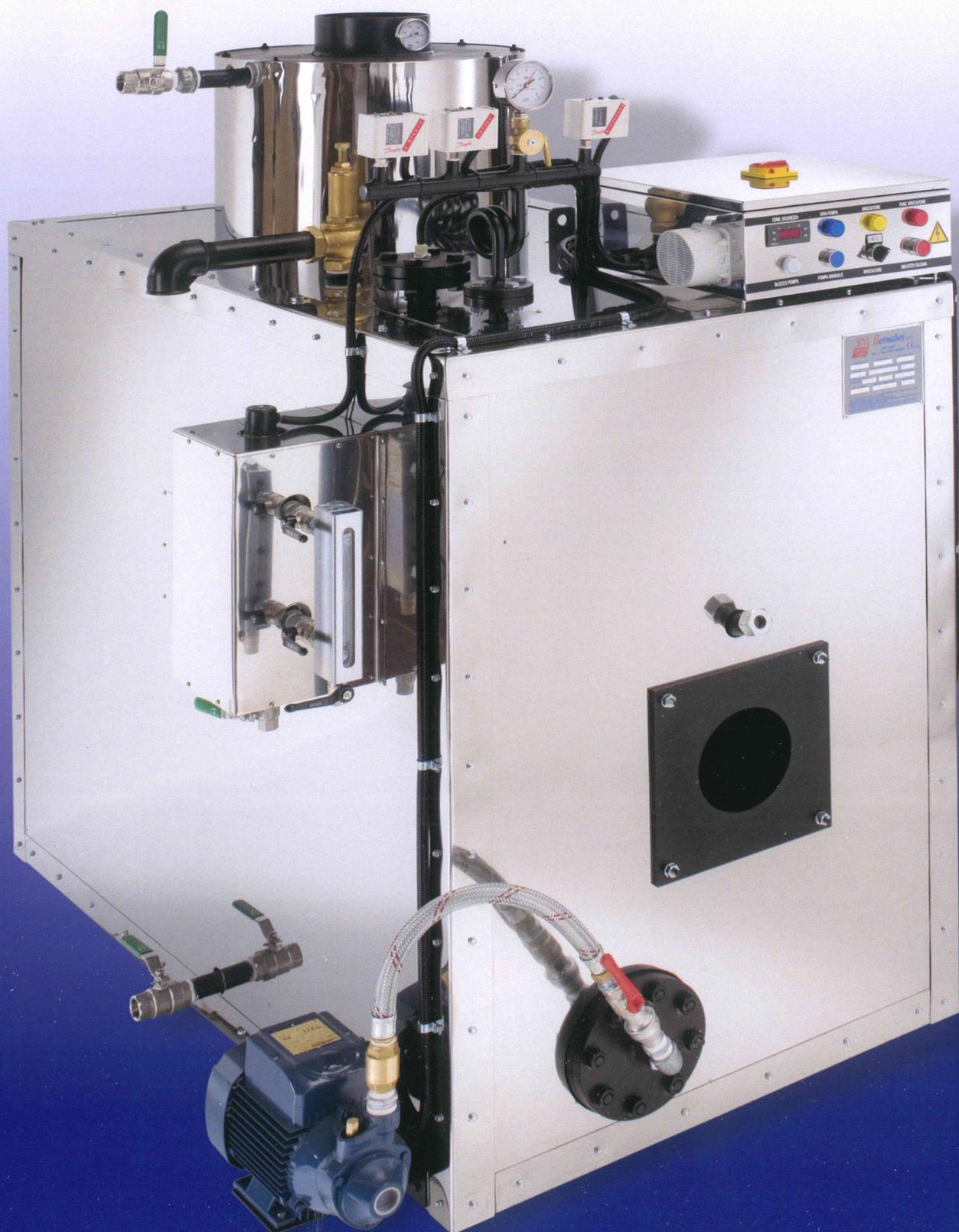
Produzione da 50 a 600 kg./h. Costruito con materiali altamente selezionati, offrendo così la massima garanzia di sicurezza e qualità. Costruito con il metodo a tubi d'acqua collegati con collettore inferiore per la deposizione fanghi facilmente ispezionabili.
